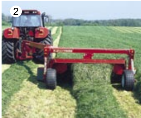
JF-STOLL slåmaskiner har en arbejdsbredde fra 1,7 m og op til 14,5 m. De kan bredsprede og lægge enkelt- eller dobbelt skår.
