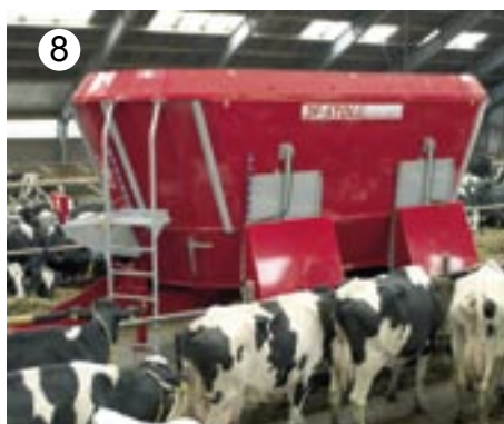
JF-STOLL's program af foderblandevogne består af både padle- og vertikalblendere med et rumfang fra 6.5 til 45 m 3 .
