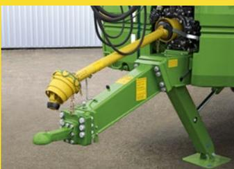
Ob Zugöse oder Kugelkopfanhängung K80: Beide garantieren eine perfekte Anhängung der Feldspritze an Ihren Traktor.
