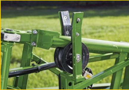
**Die Gestängedämpfung BoomGuard** sichert dem Gestänge eine herausragende Stabilität und Aufhängung sowohl beim Spritzen auf dem Feld als auch beim Straßentransport:
