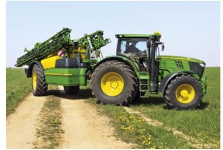
Zur leichteren Steuerung verfügt die R962i über eine proportional arbeitende Achsschenkelenkung. Diese lässt sich manuell oder automatisch und in Verbindung mit Section Control sogar GPS-gestützt steuern.
