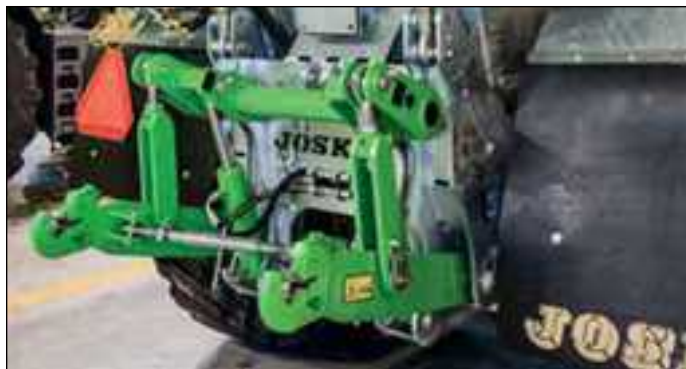
Relevage Lift intégré à la cuve sur VOLUMETRA
