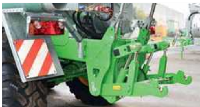
Relevage Lift intégré (relevage complètement intégré au châssis) sur QUADRA, X-TREM, VOLUMETRA, TETRAX et EUROLINER
