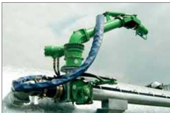
Agitation volumétrique avec retour en cuve par vanne 3 voies hydraulique
