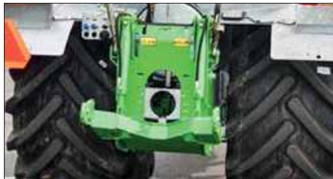
Relevage L600 sur COBRA (fixé par 4 axes coniques pour en faire un ensemble robuste)
