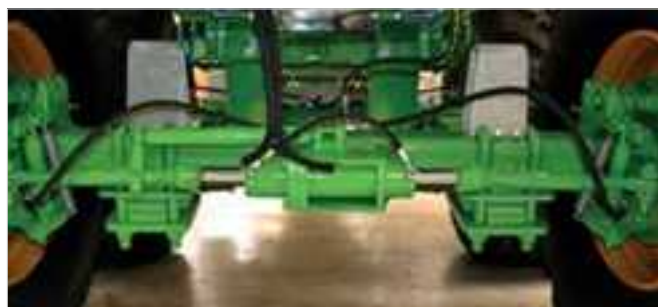
Essieu suiveur (50 % directionnel)
