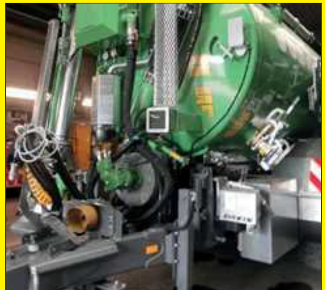
STORM avec entraînement hydraulique Power-Pack
