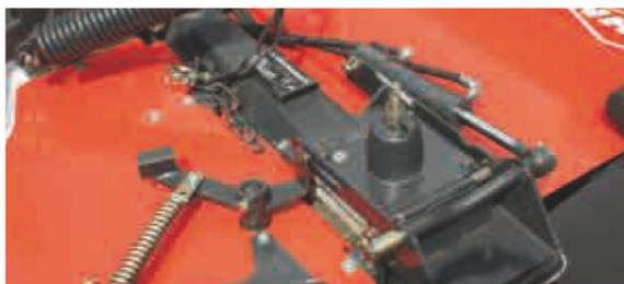
Die neuen PZ 281 F und PZ 321 F Modelle sind mit einem direkten Antrieb ausgestattet. Durch die Drehung des Getriebes wechselt die Drehrichtung. Die Getriebeeingangswelle ist immer in 70 cm Höhe und passt so zu jedem Traktor. Mit in das Getriebe integrierten 1000 und 740 U/min sind keine extra Teile notwendig. Serienmäßig ausgestattet mit cw und ccw Drehrichtung sowie auch interrierter Freilaufkupplung. Eine hydraulische Einklappung der Seitenabdeckungen ist als Sonderausrüstung erhältlich.
