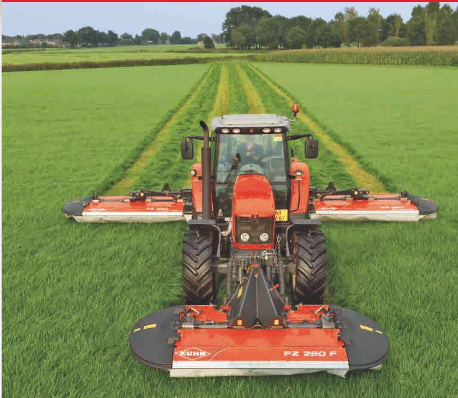
**Überall, wo größte Mähbreiten gefragt sind, ist die Mähwerkskombination PZ 960 die richtige Lösung. Mit ihren zwei Mähwerkseinheiten (PZ 320) lassen sich in Kombination mit einem Frontmäherwerk Arbeitsbreiten von bis zu 8,95 m erreichen. Betriebe, die über Traktoren im Leistungsbereich ab 85 kW/115 PS verfügen, können nun höchste Flächenleistungen beim Mäheinsatz erzielen.**
