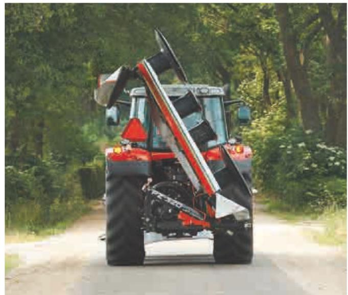
Beim Transport ist die Maschine in einem Winkel von 120° angeordnet. Ihr Gewicht wird dadurch gleichmäßig zwischen den Traktorhinterrädern verteilt. Transportsicherheit und Fahrkomfort werden deutlich erhöht, und die Traktorbeleuchtung ist jederzeit deutlich sichtbar. Durch eine neue Geometrie des Zwischenrahmens konnte die Transporthöhe auf 3,60 m verringert werden, und das bei einer Bodenfreiheit von 40 cm. In Arbeitsposition beträgt die Bodenfreiheit des Zwischenträgers 50 cm.
