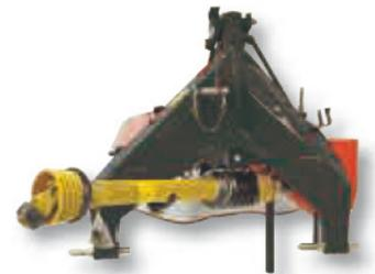
Zum Straßentransport werden die PZ Mähwerke einfach und bequem vom Traktorsitz aus mittig hinter den Traktor geschwenkt. Als Sonderausrüstung ist ein hydraulischer Hochstellzylinder lieferbar, mit dem das Mähwerk in die vertikale Transportposition gebracht werden kann.
