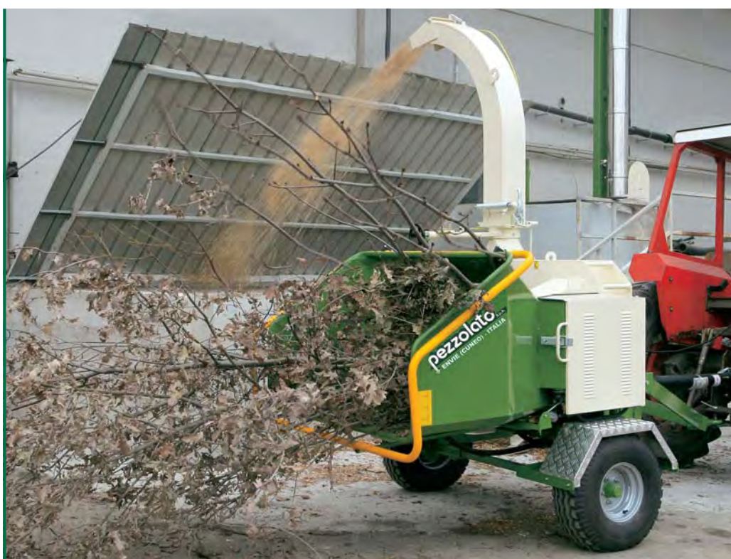
PZ 250 G allestita su carrello a bassa velocità, al lavoro. Questa versione è fornita di serie con attacco a tre punti e piedi d'appoggio.
