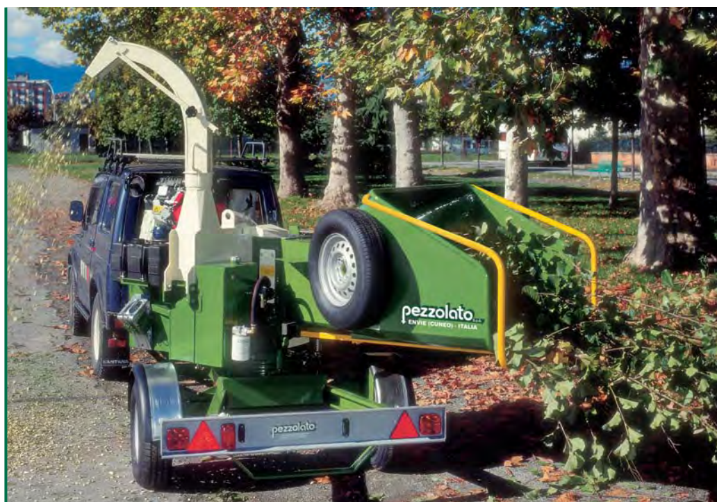
La versione PZ 150 MB al lavoro. È azionata con motore a benzina da 20 Hp e montata su carrello per traino a 80 km/h. È stata dotata di ralla girevole che consente di posizionare la bocca di carico in modo da agevolare al massimo l'ingresso del materiale da tritare.
