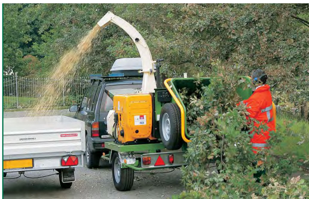
La versione PZ 190 M al lavoro. È azionata con motore Diesel HATZ da 52 Hp, silenziato e montata su carrello per traino a 80 km/h. Anche questa macchina – a richiesta – può essere allestita su carrello "tandem" con ralla girevole.
