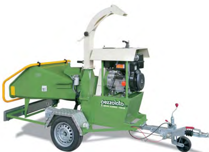
...avec essieu mono axe pour traction à 130 km/h...
