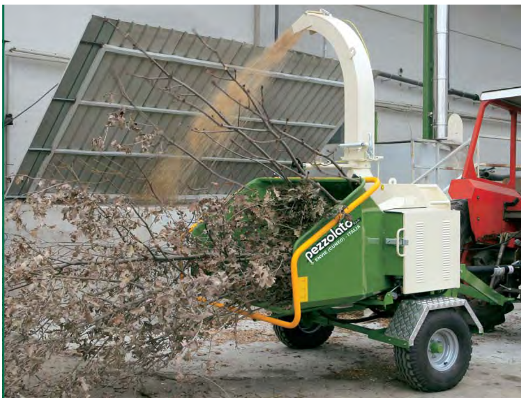
PZ 250 G montée sur chariot pour traction agricole, au travail. Cette version est fournie de série avec attelage trois points et pieds d'appui.
