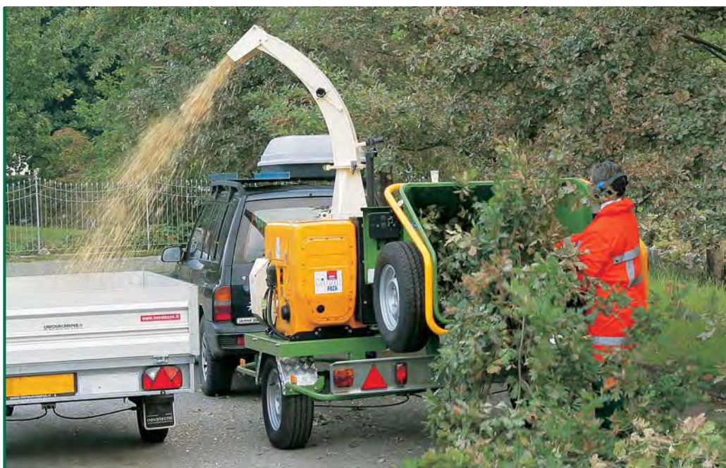
La version PZ 190 M est actionnée par un moteur Diesel HATZ de 52 CV, silencieux, et montée sur chariot pour traction à 80 km/h. Cette machine – sur demande – peut être également montée sur essieu "tandem" avec tourelle pivotante.
