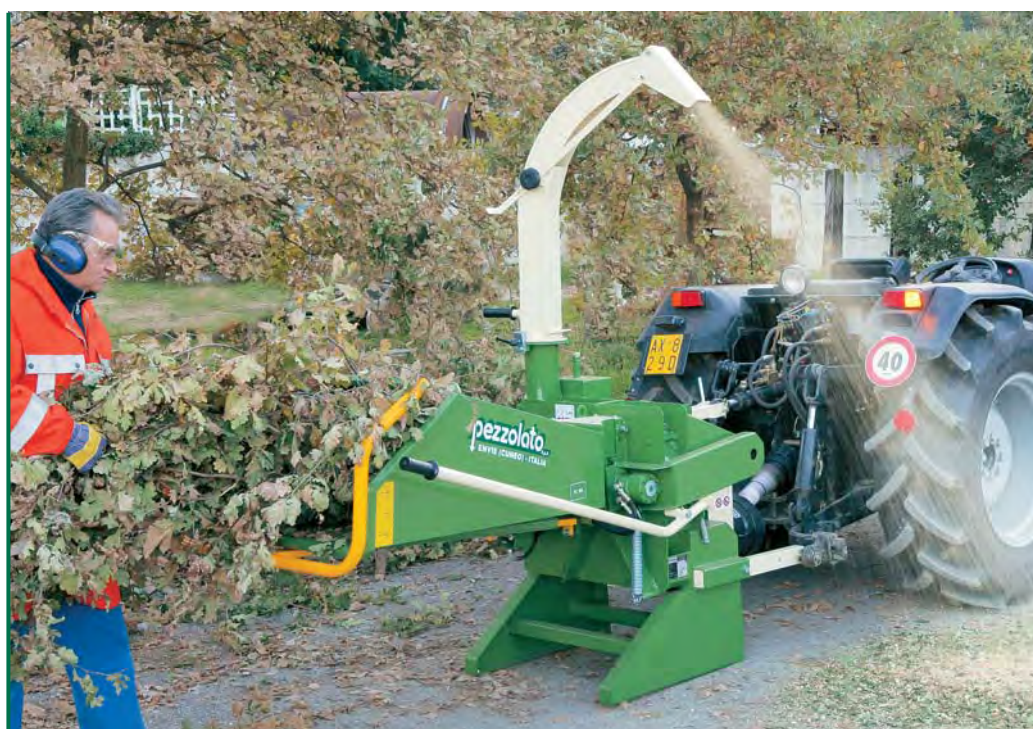
La version PZ 100 G actionnée par prise de force est équipée d'attelage trois points du tracteur.
