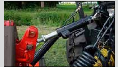
FRONTFLEX-Teleskop-Oberlenker (nur für schwenkbaren Anbaubock geeignet)
