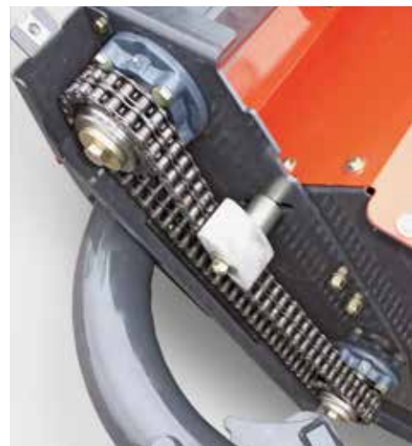
Die Aufbereiterdrehzahl (815 min -1 ) kann durch Austauschen der Zahnräder auf 650 min -1 reduziert werden
