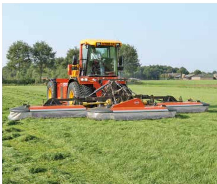
Mit geringfügigen Anpassungen und einem Montagesatz für das Frontmäherwerk lässt sich die Schmetterlingskombination auch in Schubfahrt einsetzen
