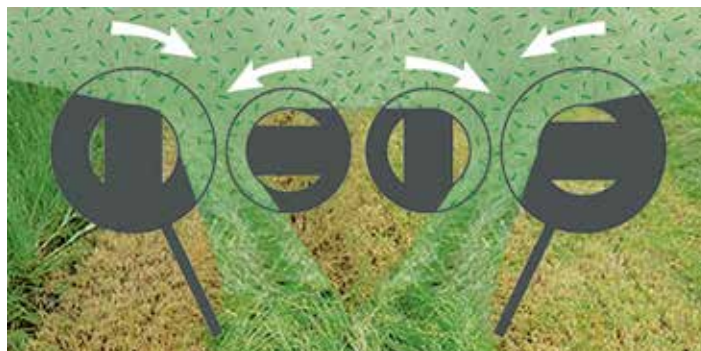
Kleine und große Messertellern für schmale Schwadablage
