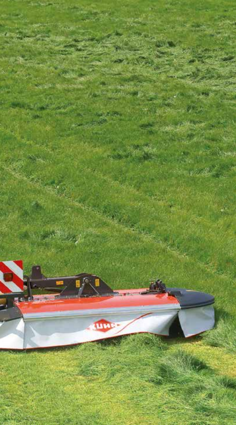
Einzelaushub der Mäheinheiten des PZ 960 durch serienmäßige Ausrüstung mit Mehrwegeventil
