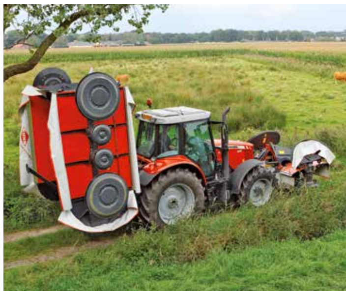
Zum Straßentransport werden die Mäheinheiten über einen Hydraulikzylinder hochgeschwenkt. Die Transportbreite liegt unter 3,00 m
