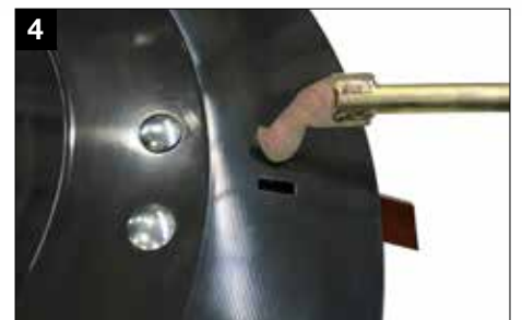
Messerwechselsystem mit Sonderwerkzeug und Messerhalter
