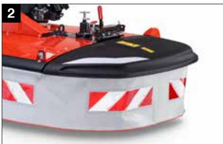
Überarbeitete flexible FLEXPROTECT-Seitenverkleidungen
