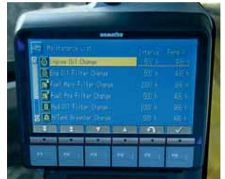
Der LCD-Monitor zeigt Unregelmäßigkeiten und Wartungsintervalle an
