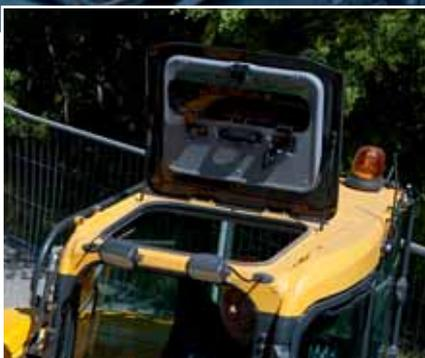
Aufklappbare Dachluke für optimale Sicht nach oben
