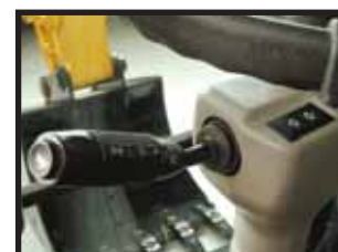
Odchylane koło kierownicy z włącznikiem wycieraczek, kierunkowskazów, sygnału dźwiękowego i reflektorów
