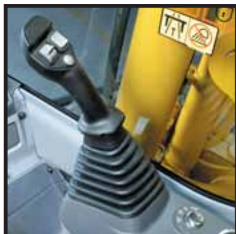
Gravespaker med brytere for proporsjonalstyring av redskaper
