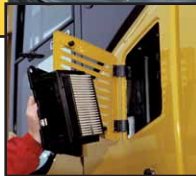
Filtro de entrada de aire
