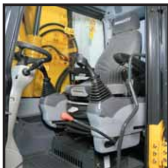
Desplazamiento del asiento: 340 mm
