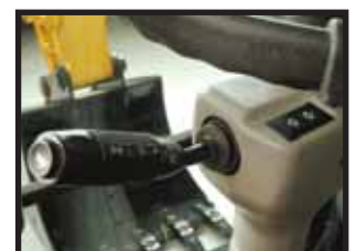
Volante inclinable con varias funciones: control de limpiaparabrisas, intermitentes, claxon y luces delanteras
