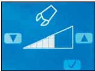
Pantalla de ajuste preciso del caudal hidráulico en el modo P (Power) o E (Economy)
