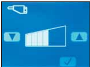
Pantalla de ajuste preciso del caudal hidráulico en el modo B (Breaker)
