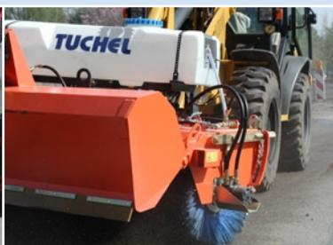
Système de pulvérisateur anti-poussière / fonction balayage simple standard
