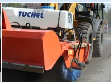
Staubbinding durch Wassersprüheinrichtung, Freikehrmodus serienmäßig
