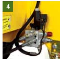
**4- HYDRAULISCHER ÖLMENGENTEILER**
