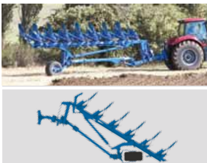
Keine Verstellung der Arbeitsbreite beim Einschwenken des Rahmens während des Drehens
