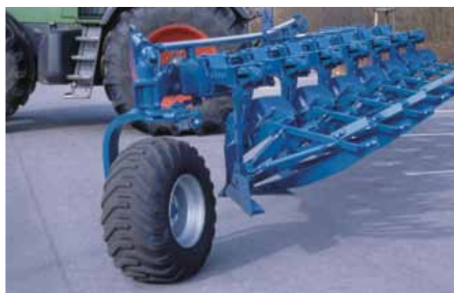
Großvolumiges Aufsattel- und Transportrad (400/60-15.5) mit automatischer Lenkung für enge Kurvenfahrt
