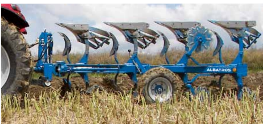
Geringer Schwerpunktabstand durch Bogengrindel
