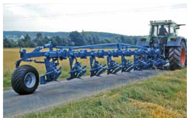
Tragbrücke zur Erhöhung der Rahmenstabilität ab 7-furchig
