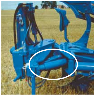
Kompaktes Einstellzentrum mit Hydraulikzylinder der Rahmenschenkeinrichtung
