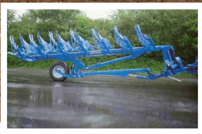
Niedriger Schwerpunkt und geringe Seitenkräfte während des Drehens durch integrierte Rahmenschenkeinrichtung
