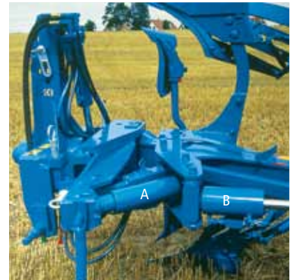
Getrennte Hydraulikzylinder für Rahmenschnwenken (A) und Arbeitsbreitenverstellung (B)
