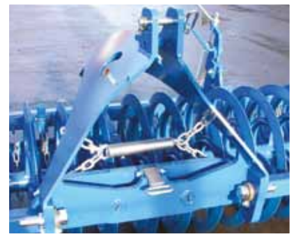
Frontdreipunkturm lenkbar durch Rollenführung mit Schwingungsdämpfung
