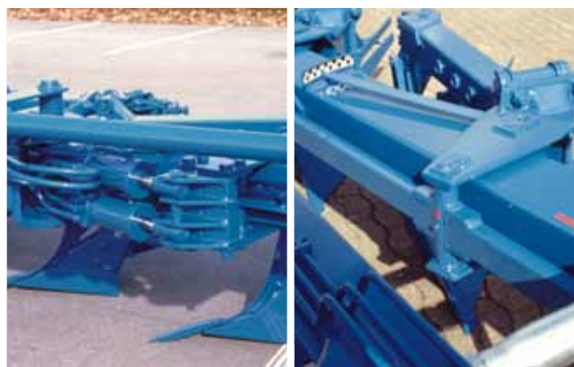
Stufenlose hydraulische Arbeitsbreitenverstellung Variant zur Anpassung an unterschiedliche Einsatzbedingungen
