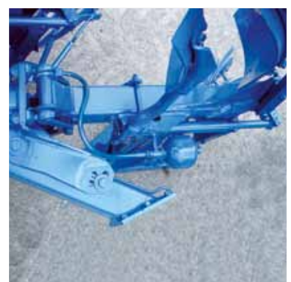
Konsole mit hydraulischer Steinsicherung HydroAvant
