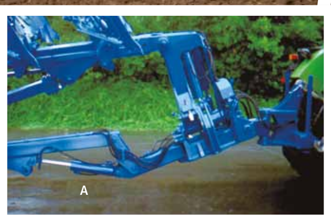
Hydraulikzylinder (A) für kombiniertes Rahmenschenken und Anpassung der Erstkörperschnittbreite
