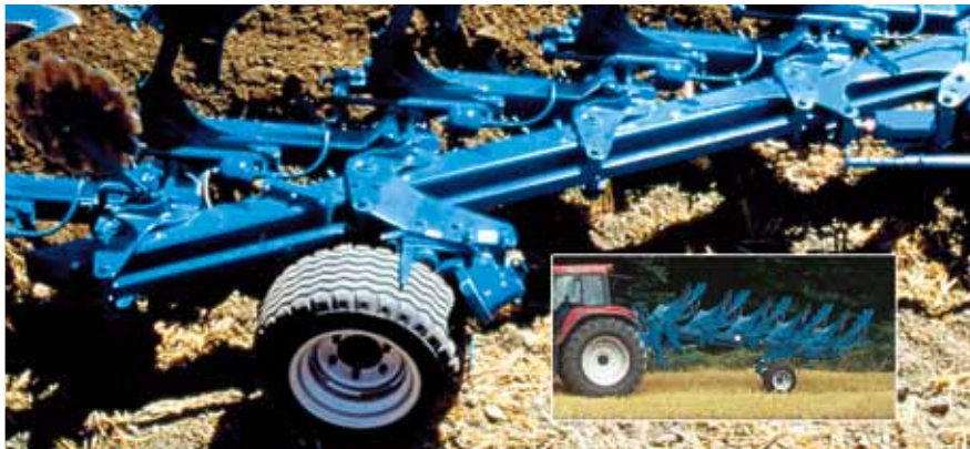
Kombirad für gleichmäßige Tiefenführung und schonenden Straßentransport mit kombiniertem Dämpfungs- und Schwenkzylinder und hydraulischer Arbeitstiefenverstellung
