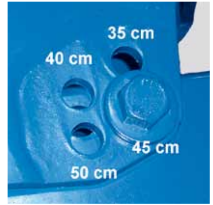
Arbeitsbreiten von 30 cm bis 50 cm in vier Stufen
