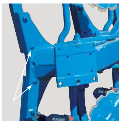
Konsole mit Scherschraubensicherung
