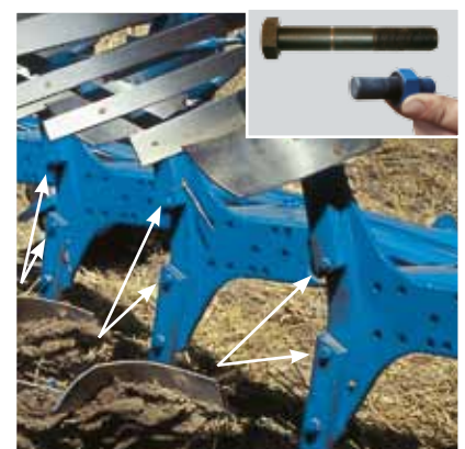
Bei allen Pflügen ohne HydroAvant Überlastsicherung durch Scherschraube mit Abrissnut für genaues und sauberes Abschern
