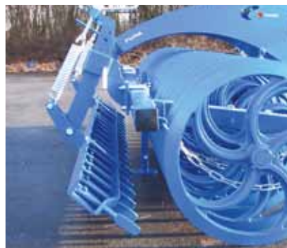
Optional: Planierschiene mit Zinken, mehrfach verstellbar, für bessere Einebnung und Zerkleinerung des Bodens
