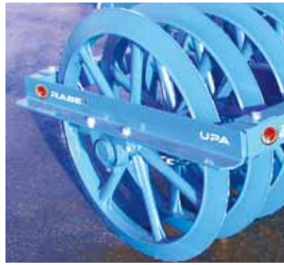
Bruchfester Ring aus Sphäroguss, Ø 900 mm, Universal-Ringprofil: Schneide 38°, Schulterbreite 65 mm
