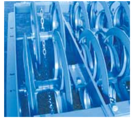
Sichere Reinigung der Ringe durch Abstreiferketten
