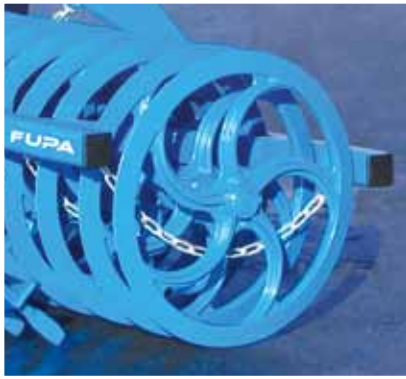
Bruchfester Ring aus Sphäroguss, Ø 700 mm, geschwungene Speichen für besonders hohe Stabilität, Universal-Ringprofil: Schneide 35°, Schulterbreite 33 mm
