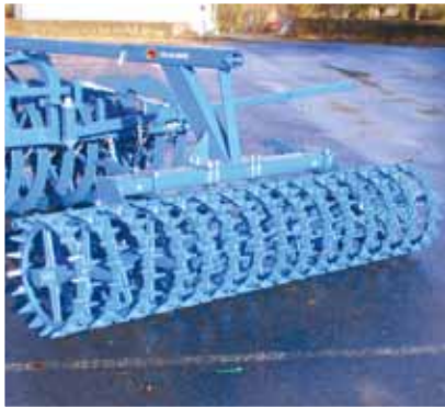
Nockenwalze (Ø 55 cm) für zusätzliche Krümelung und Rückverfestigung
