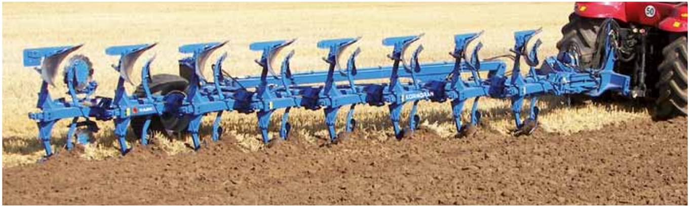
Kormoran HA mit hydraulischer Steinsicherung HydroAvant
