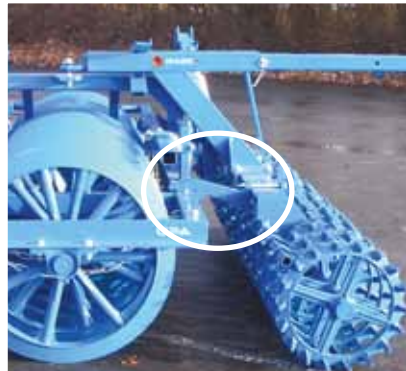
Auflieger für Straßentransport zusammen mit dem Untergrundpacker
