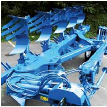
Die Konsolen sind an den Rahmen geflanscht
