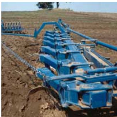
Milan VHA mit hydraulischer Steinsicherung HydroAvant
