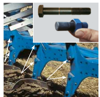
Überlastsicherung an den Grindeln bei allen Kormoran- und Marabutypen durch Scherschraube mit Abrissnut für genaues, sauberes Abscheren
