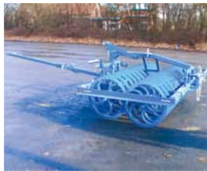
Abgefederte, höhenverstellbare Fangarme mit nachstellbarer Bremse, ab 2,10 m Arbeitsbreite mit Stoßdämpfer
