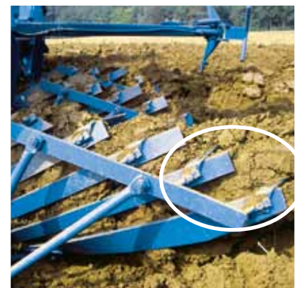
Schollenbrecher für zusätzliche Bodenkrümelung direkt am Streichblech
