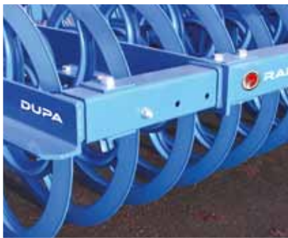
Arbeitsbreite erweiterbar durch Teleskoprahmen
