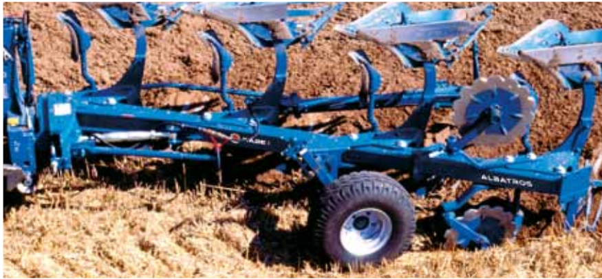
Tastrad für gleichmäßige Tiefenführung mit Anschlagpuffer und Gelenk am Tastradstiel, kann weiter vorn oder hinten montiert werden
