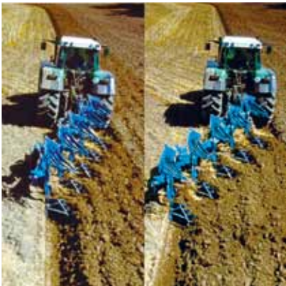
Stufenlose Arbeitsbreitenverstellung von 33 cm bis 53 cm
