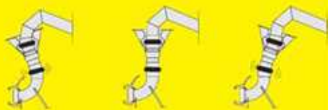
De kop van de trechter en van de arm zijn beweegbaar om voor een permanente afdichting van de koppeling bij het aanzuigen te zorgen.
