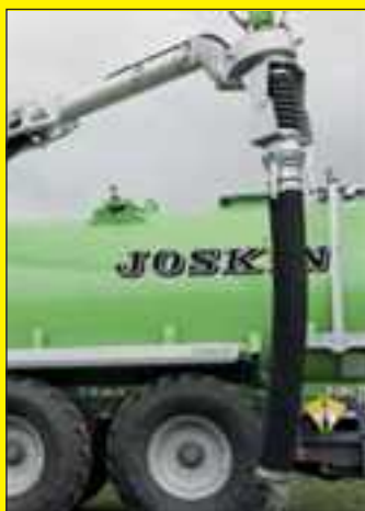
Tuyau d'aspiration flexible
