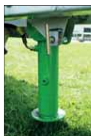
Béquille hydraulique escamotable
