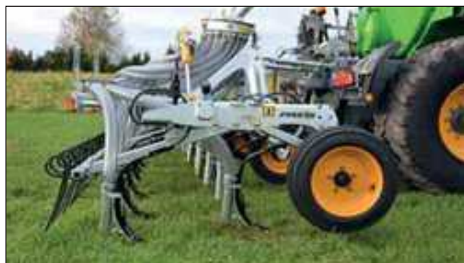
TERRAFLEX/2 muni d'une herse nivelleuse
