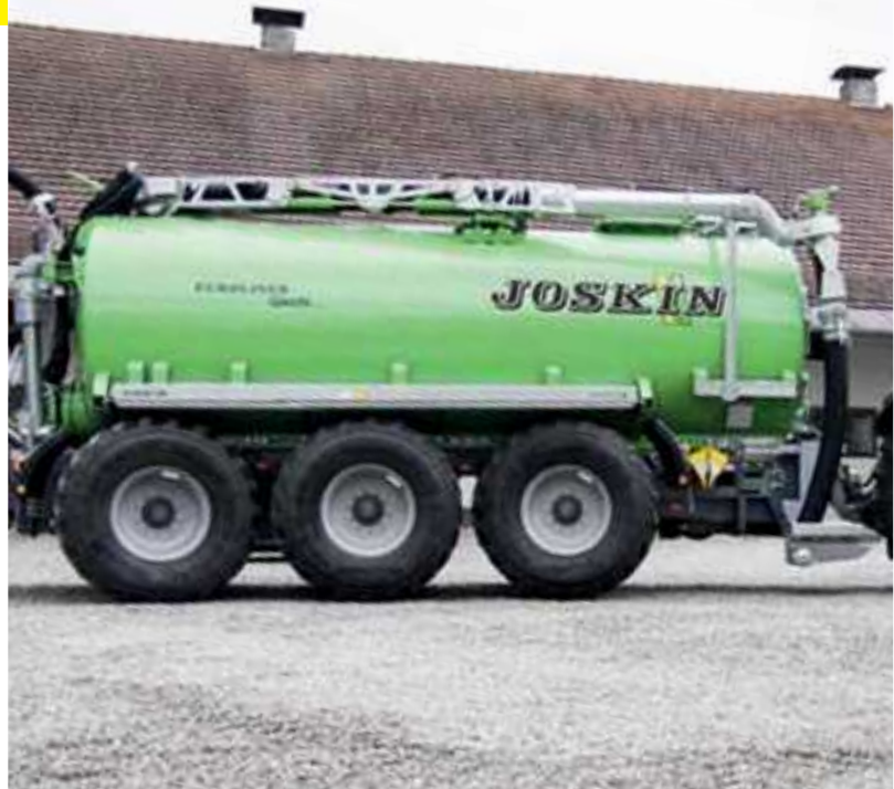
Flèche dorsale avec point de pivot à l'arrière
