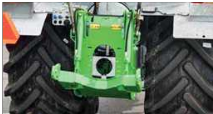
Relevage L600 sur COBRA (fixé par 4 axes coniques pour en faire un ensemble robuste)
