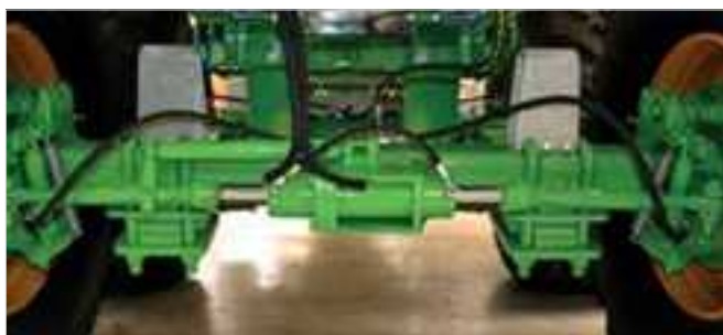
Essieu suiveur (50 % directionnel)
