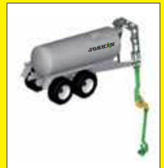
Flèche avant avec turbo immergé
