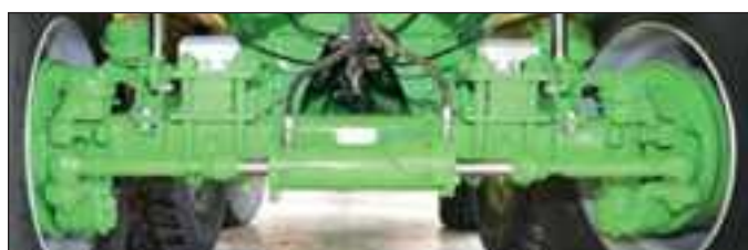
Essieu directionnel forcé (100 % directionnel)
