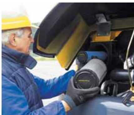
Il cofano posteriore garantisce un rapido controllo del vano motore direttamente da terra
