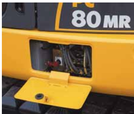
L'interruttore stacco batteria è standard
