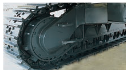
Robuster Schutz der Fahrmotoren
