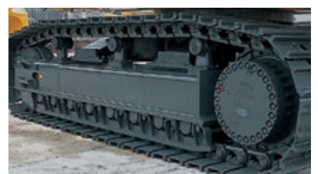
Laufrollenschutz über die gesamte Laufwerkslänge (Option)
