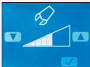
Meny för finjustering av hydrauloljeflödet i läge P eller E (Power- och Ekonomiläge)
