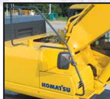
Stort räcke för säker uppstigning
