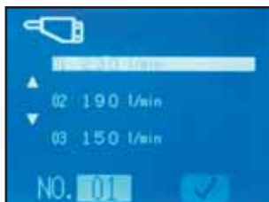
Meny för allmän justering av hydrauloljeflödet i läge B (hammarläge)
