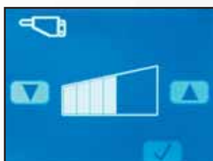
Meny för finjustering av hydrauloljeflödet i läge B (hammarläge)
