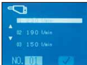
Hydraulikkavirtauksen yleinen säätönäyttö B-työtavalla (iskuvasaran käyttö)
