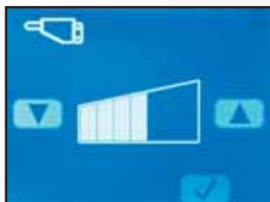
Hydraulikkavirtauksen säätönäytön hienosäätö B-työtavalla (iskuvasaran käyttö)
