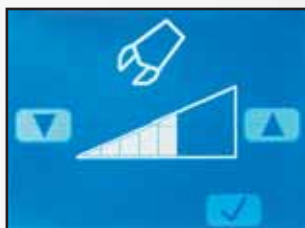
Hydraulikkavirtauksen säätönäytön hienosäätö työtavoilla P (power) tai E (säästö)
