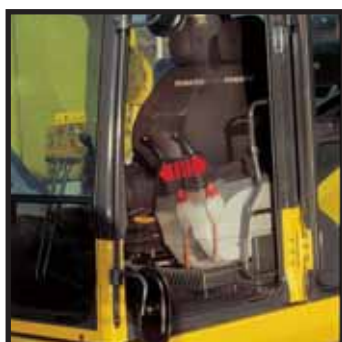
Istuimen säätöalue: 340 mm – 120 mm enemmän kuin ennen
