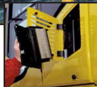
Filtro aria interno cabina La facile rimozione/installazione dell'elemento del filtro aria interno cabina, senza necessità di attrezzi, semplifica le operazioni di pulizia.
