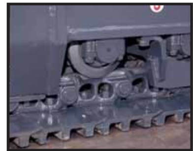
Maglia cingolo con montante Il PC340-7 impiega maglie cingoli con montante che garantiscono una maggiore resistenza e durata.
