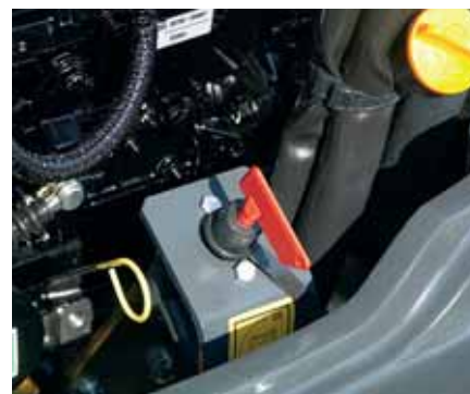
Coupe circuit de l'installation électrique en standard
