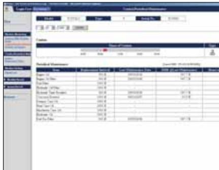
Underhållsplanering – För att öka produktiviteten och förbättra underhållsplanering indikerar larm när saker såsom filter eller olja måste bytas ut.
