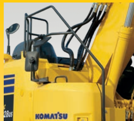
Handläufe und rutschfeste Oberflächen
