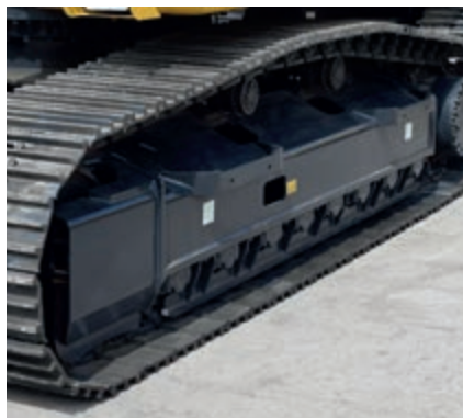
Laufrollenschutz über die gesamte Laufwerkslänge (Option)
