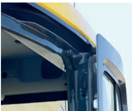
Die Schiebetür ist der abgerundeten Kabinenform angepasst und somit perfekt gegen Beschädigungen geschützt
