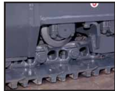
Rupsketting uitgevoerd met extra versteviging De PC210-7 gebruikt een ketting met extra versteviging in het midden voor meer duurzaamheid
