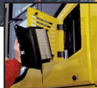
Yttre luftfilter Enkelt byte/installation av filterelementet i klimatanläggningen. Filtret byts och rengörs utan verktyg.
