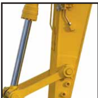
Ledningar för snabbkopplingar (standard)
