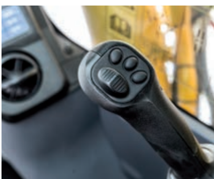
Joysticks mit Proportionalsteuerung für Anbaugeräte
