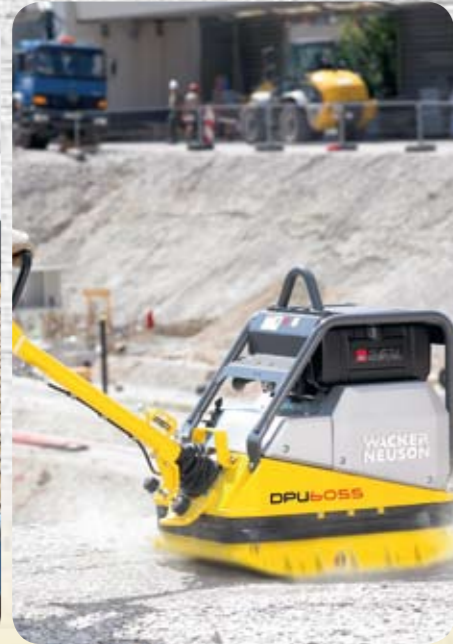
Schritt 2: Der Boden wird vorbereitet und vor der weiteren Verarbeitung verdichtet. Je nach Größe der Fläche hat Wacker Neuson ein breites Angebot an Vibrationenplatten im Sortiment.
