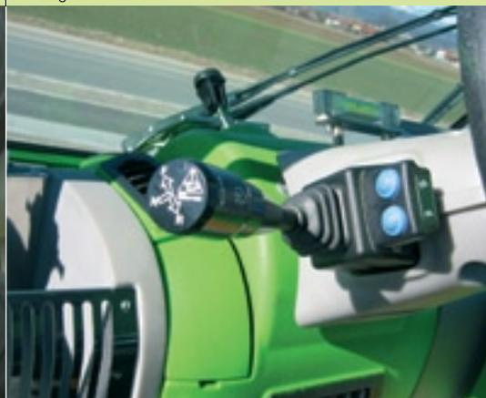
Le joystick électronique permet de varier la vitesse de levage et de sortie de la flèche en fonction du poids du chargement transporté.
