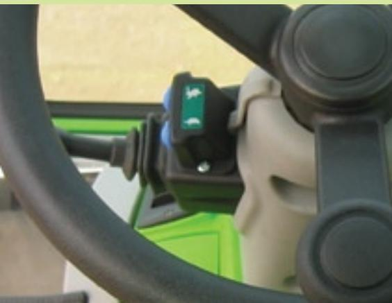
L'inverseur électro-hydraulique système Finger-Touch positionné à côté de la direction, permet à l'opérateur d'effectuer le changement du sens de marche sans ôter les mains du volant.
