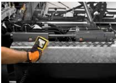
Hydraulische Höheneinstellung für ausfahrbare Bohlenanbauteile
