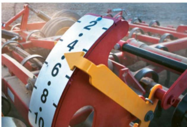
Utilizzando la Funzione di Controllo è possibile regolare la profondità di lavoro a seconda delle condizioni del terreno, in movimento e dal posto di guida.
