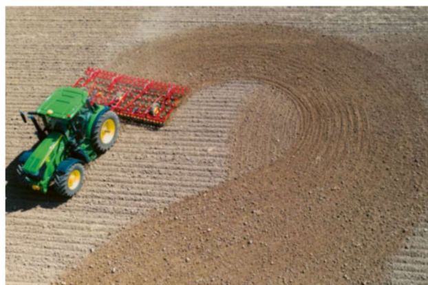
L'attelage articulé permet de tourner avec le NZ Mounted en position de travail.
