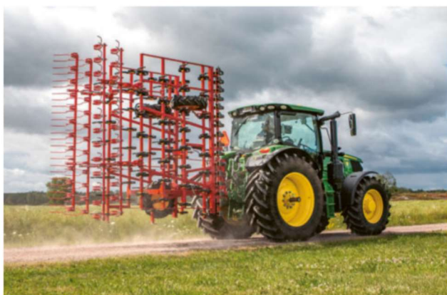
Le NZ Monted se plie pour une largeur de 2,05 mètres, assurant un transport pratique entre les champs.
