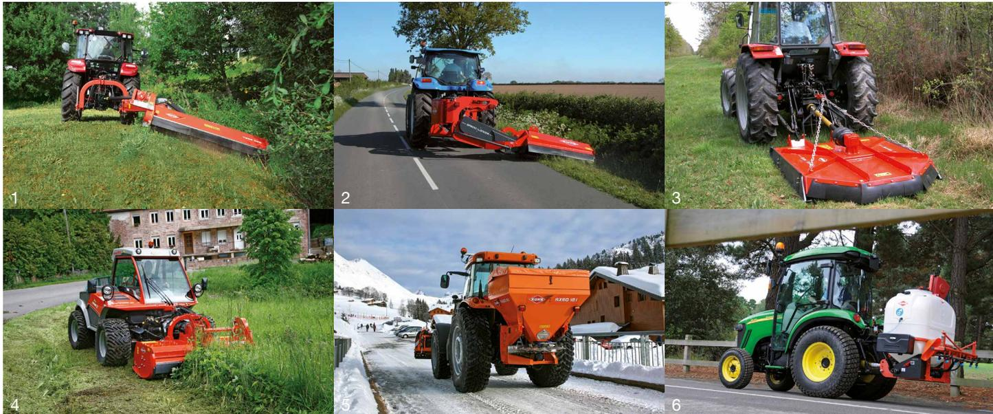
1. Böschungsmulcher mit 1,61 bis 2,49 m - 2. Randstreifenmäher mit 1,60 bis 2,30 m im Front- und Heckanbau - 3. Spezialmulchergeräte für Kleintraktoren und Sichelmulchergeräte - 4. Mulchergeräte mit 1,75 bis 2,10 m für Hangschiepfer - 5. Salz- und Sandstreuer - 6. Spritzenprogramm für Gartentraktoren.
