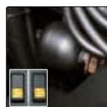
**Gli accumulatori a gas** assorbono una buona parte delle oscillazioni che si generano soprattutto durante la marcia su strada con macchine portate pesanti.
