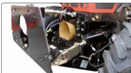
**Piastra di montaggio frontale** per attrezzi comunali. Gli attrezzi montati vengono guidati in modo preciso attraverso l'assale anteriore.
