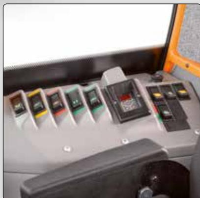
Nei **comandi laterali** sono disponibili ulteriori funzioni idrauliche, ubicate in modo ergonomico e identificate con colori diversi quali disattivazione del sollevatore, scarico attrezzo frontale, antioscillazione o motore idraulico (a seconda della versione idraulica desiderata).
