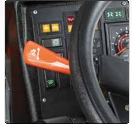
I cambi di direzione possono essere eseguiti sia repentinamente che più delicatamente grazie allo **shuttle A/R**.
