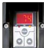
Il **display digitale** fornisce informazioni sulla pressione di scarico impostata che può essere preselezionata mediante tasto. L'elettronica effettua automaticamente il caricamento e garantisce che la pressione di scarico selezionata venga mantenuta.
