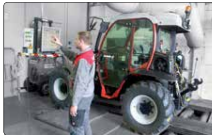
Alle Fahrzeuge werden vor der Auslieferung einer intensiven Funktionsprüfung wie z.B. am Rollenleistungsprüfstand (Bild) unterzogen.
