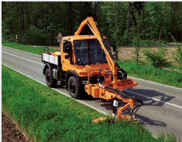
Solobetrieb mit dem Randstreifen-Mähgerät
