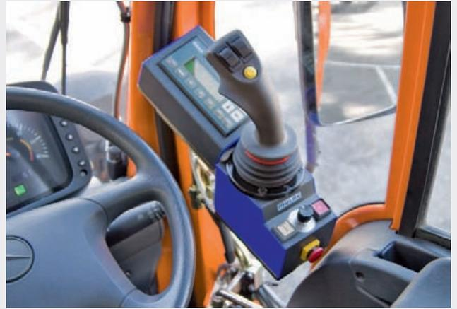
Kombinationsbedienung beider Mähgeräte mit einem Joystick
