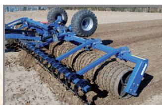
Der großdimensionierte "XL" Rahmen ist serienmäßig vorbereitet für die Ausstattung mit hydraulischem Crackerboard oder einer gefederter Maulwurfplanke.
