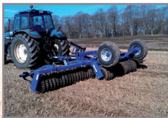
Die kompakte Bauweise der MINIMAX mit großer Bodenfähigkeit, optimaler Stützlast und großdimensionierter Bereifung gewährleistet Transportsicherheit selbst in schwierigstem Gelände.
