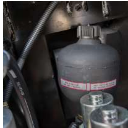
Accumulatore di pressione Migliora l'idraulica e la sicurezza della macchina.
