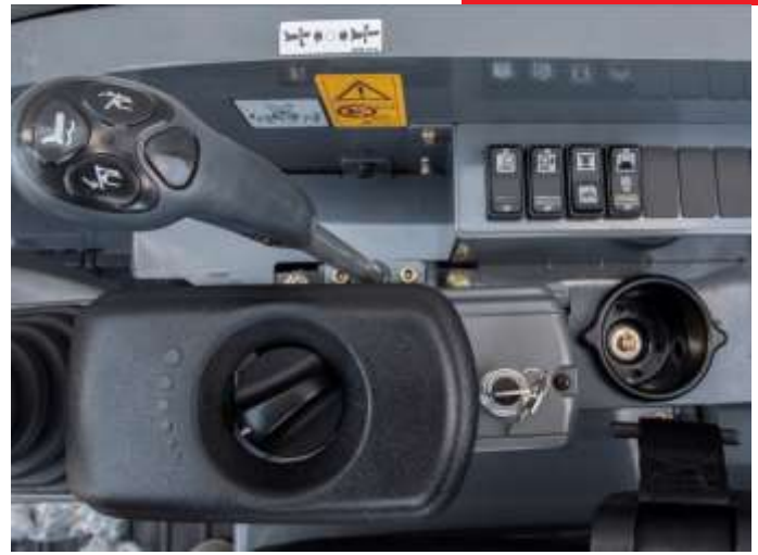
Comandi: fari, deceleratore, modalità Power/Montagna e funzionamento a scatto.
