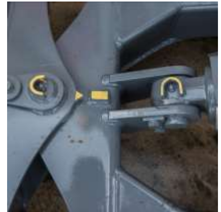
Punti di ingrassaggio protetti dalla struttura e ben visibili.
