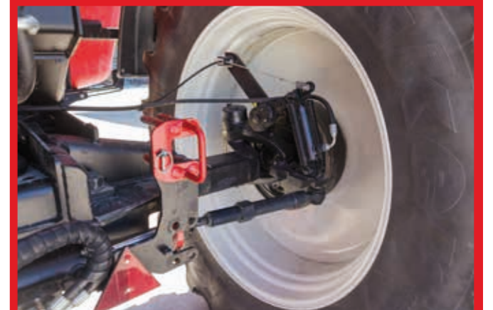
Achsschenkellenkung mit bis zu 54° Lenkeinschlag für exakte Spurtreue.
