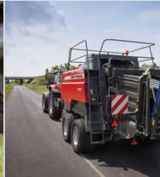
Die Tandemachse ermöglicht hohe Transportgeschwindigkeiten und bietet höchsten Fahrkomfort zwischen den Feldern.
