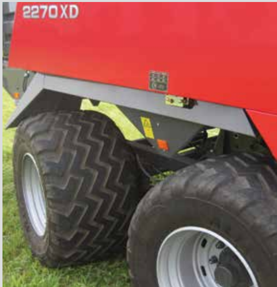
Optionale Niederdruck-Radialreifen der Größe 620/40R22.5.
