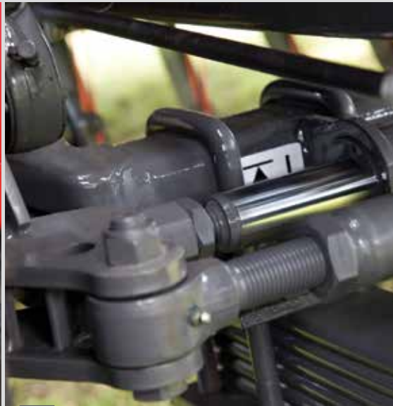
Hydraulische Lenksperre der Hinterachse.
