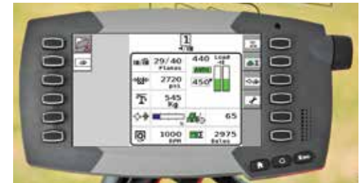
Automatische Regelung der Pressdichte über das Bedienterminal C1000.
