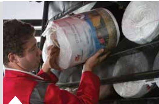
Einfache Befüllung der „Easy-Fill“-Garnkästen.
