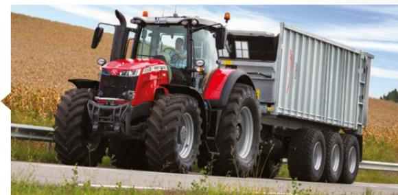
**Mayor seguridad en la carretera.** Todos los tractores de la serie MF 8700 S están equipados de serie con sistemas de frenado neumático para remolque, incluida la opción de señal ABS para remolque que proporciona la máxima seguridad. Para una mayor seguridad, el nuevo sensor de pedales de freno conectados satisface los nuevos requisitos para la circulación a más de 40 km/h.
