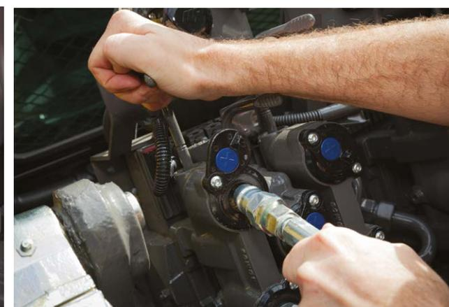
Todos los acopladores traseros disponen de un sistema de descompresión hidráulica.
