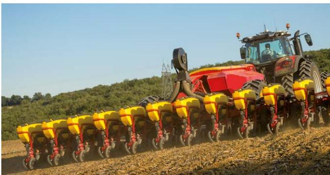
Los últimos modelos de neumáticos, incluidos los neumáticos dobles, permiten a los tractores de la serie MF 8700 S trabajar a niveles de presión de neumáticos muy bajos, incluso en trabajos que requieren una tracción alta:
