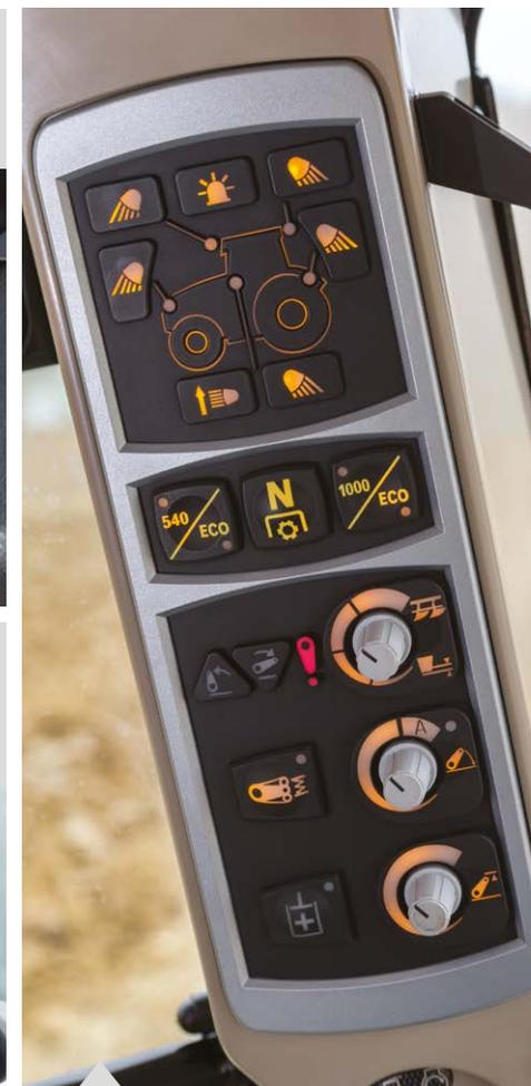
Controles de selección de la velocidad de la TDF y controles del elevador montados en el pilar.
