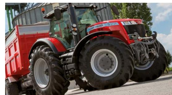
Dispone de un sistema práctico y sencillo para pasar el elevador delantero de la posición de trabajo a la posición de recogido con el fin de minimizar la longitud global del tractor cuando el elevador delantero no se necesita, como por ejemplo en las aplicaciones de transporte.
