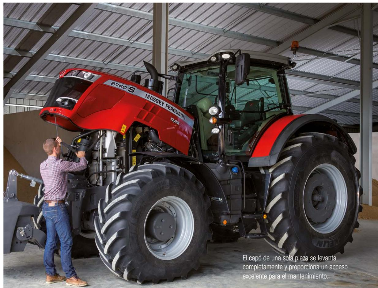
El capó de una sola pieza se levanta completamente y proporciona un acceso excelente para el mantenimiento.
