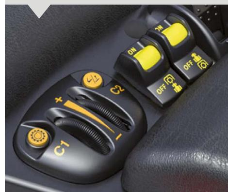
Botón de activación de la TDF, válvula hidráulica y controles del elevador montados en el guardabarros.
