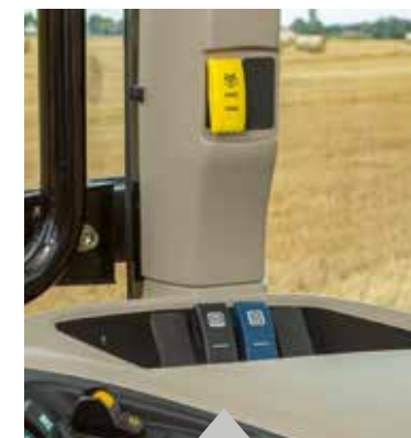
Opzione flusso "combinato" da 100 litri/min attivabile con la semplice pressione di un pulsante
