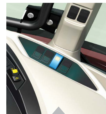
Nouvelle option de cumul de pompes 100 l/min sur simple pression d'un bouton
