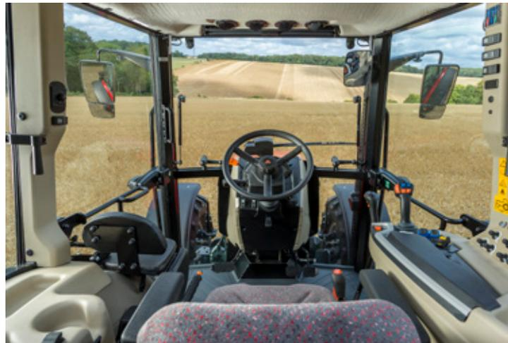
Mit der breiten Frontscheibe und den Glastüren, die bis zum Boden reichen, bietet die Baureihe MF 3700 AL hervorragende und ungehinderte Rundumsicht. Nach vorne bietet sich ein direkter Blick auf die schmale und niedrige Motorhaube – erreicht wird dies durch die externe Anbringung des Abgasreinigungssystems, wodurch eine freie Sicht auf die Räder und vorn montierte Geräte gewährleistet ist.
