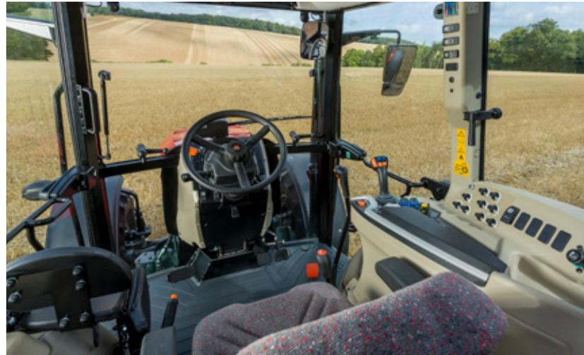
Neben dem optimierten Komfort ermöglicht die höhere Kabine (bis zu 2,55 m) dank der großen Frontscheibe über die niedrige, schmale Motorhaube sowie durch große Glastüren und Seitenfenstern hervorragende Sicht nach vorne und zu den Seiten.
