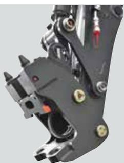
Dank der Schnellwechsellvorrichtung **ACTIVE LOCK** erfolgt das Wechseln von Anbaugeräten (Tieflöffel, Grabenräumlöffel, Schaufeln, Palettengabel, Lasthaken usw.) problemlos innerhalb von wenigen Sekunden. Und die Vielseitigkeit des 8MCRs endet hier noch nicht, denn die zusätzlichen Hydraulikanschlüsse erlauben die Verwendung von vielen Hydraulikwerkzeugen, wie etwa Hammer, Fräse, Erdbohrer, Betonmischer usw.
