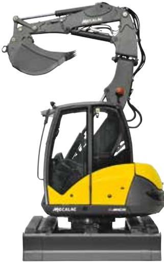
Bei der MCR-Baureihe handelt es sich um wendige und effiziente Multifunktionsmaschinen sowohl zum Baggern (Ausheben, Verfüllen) als auch zum Laden (Auf-, Ab-, Verladen und Befördern) von Paletten oder Materialien.
