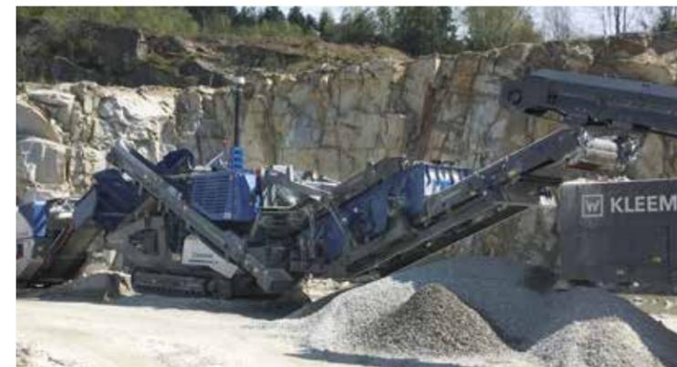
**Le MOBICONE MCO 90(i) EVO2 est équipé d'un concept d'entraînement « Diesel électrique direct » innovant, à la fois puissant et économique.**
