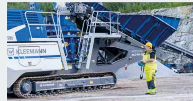
Le mobile broyeur à cône MOBICONE MCO 90(i) EVO2 possède une puissance d'entraînement élevée du broyeur constante jusqu'à 185 kW et jusqu'à 250 kW au maximum. Cela permet un processus de broyage continu et, dans des applications spéciales, un volume de production plus élevé. Grâce à une courte phase de chauffage de l'huile de lubrification,
