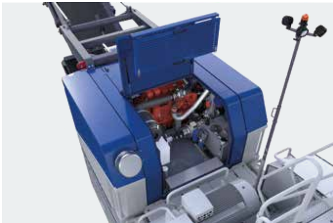
> MC 120 Z PRO - meilleure accessibilité au compartiment moteur
