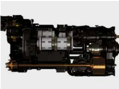
23x6 Full Powershift Getriebe mit Kriechgang
