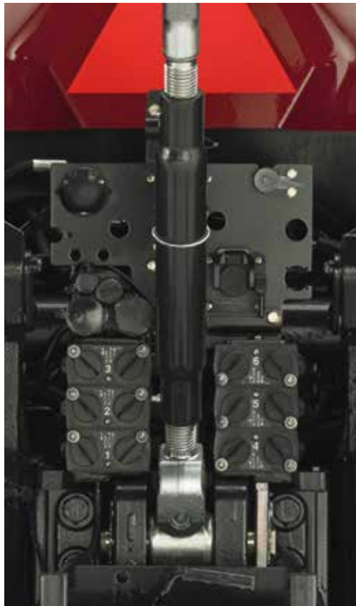
Viele Einsatzmöglichkeiten mit sechs elektro-hydraulischen Steuerventilen im Heck.
