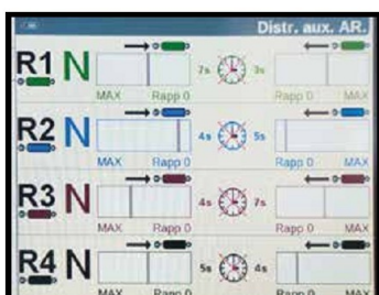
Steruj zaworami hydrauliki zewnętrznej z monitora AFS 700 Pro.
