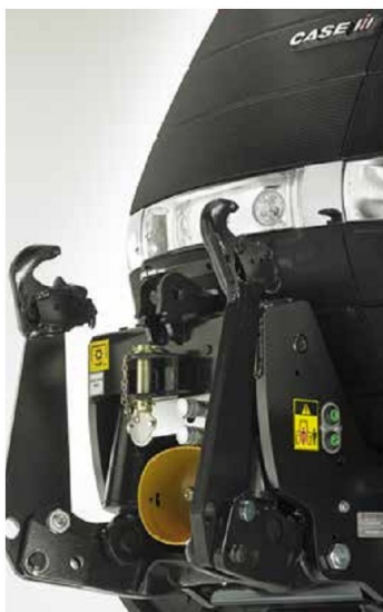
W pełni zintegrowany przedni zacpek o udźwigu 5000 kg.
