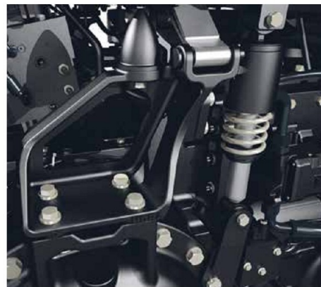
Zawieszenie kabiny zapewnia bardziej płynną jazdę zarówno po drodze, jak i po nierównym terenie.
