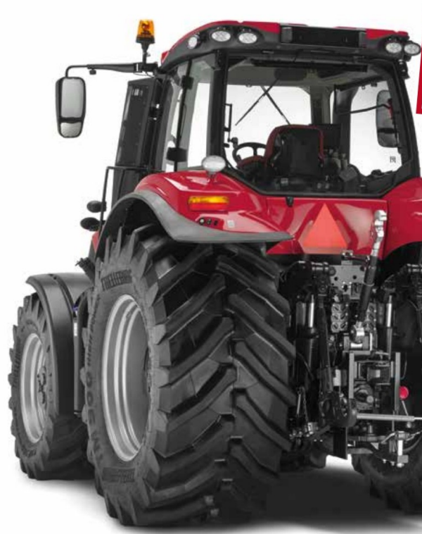
Bez limitów w użytkowaniu dzięki 6 elektrohydraulicznym zaworom hydrauliki zewnętrznej.
