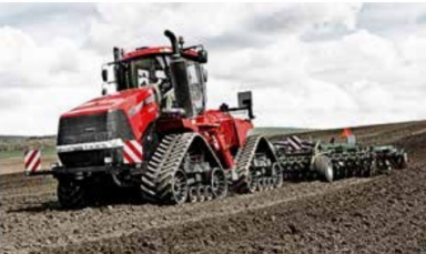
W Magnum Rowtrac zastosowano tę samą koncepcję znaną z modelu Quadtrac, a więc wykorzystano cztery punkty styku z podłożem.
