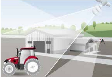
xFill pokrywa nawet 20-minutowe przerwy w odbiorze sygnału RTK.
